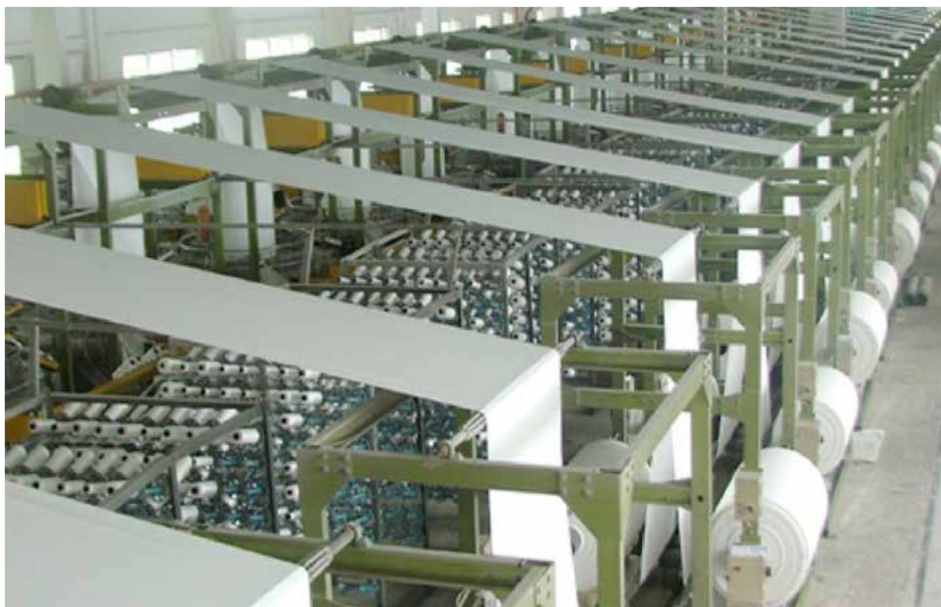
Biến tần GD200A: Điều khiển máy dệt tốc độ cao tại Nhà máy Bao Bì Vinh Hoa
