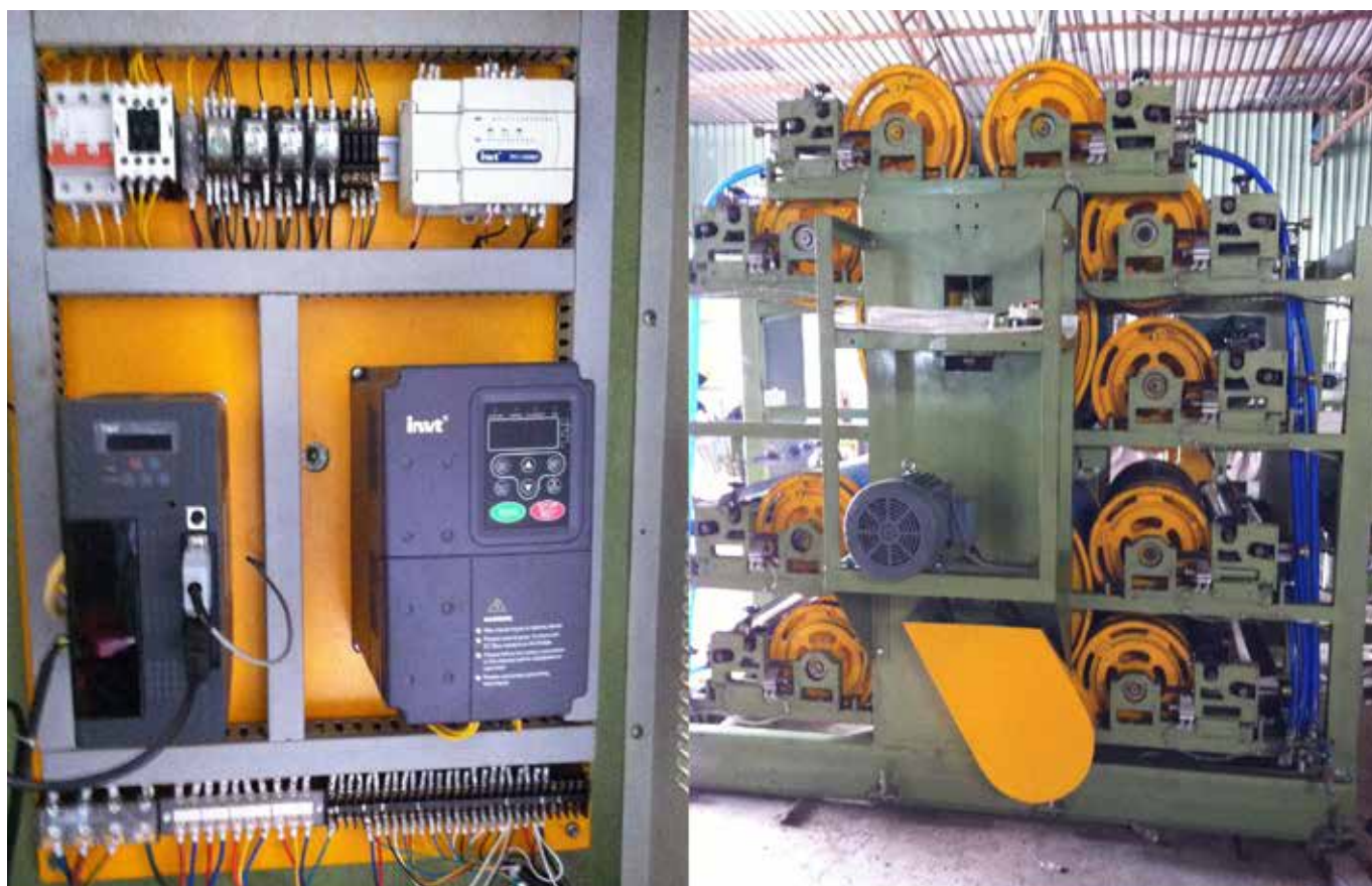
Biến tần CHF100A, Servo, PLC, HMI: Điều khiển máy in Flexo - Ngành nhựa
