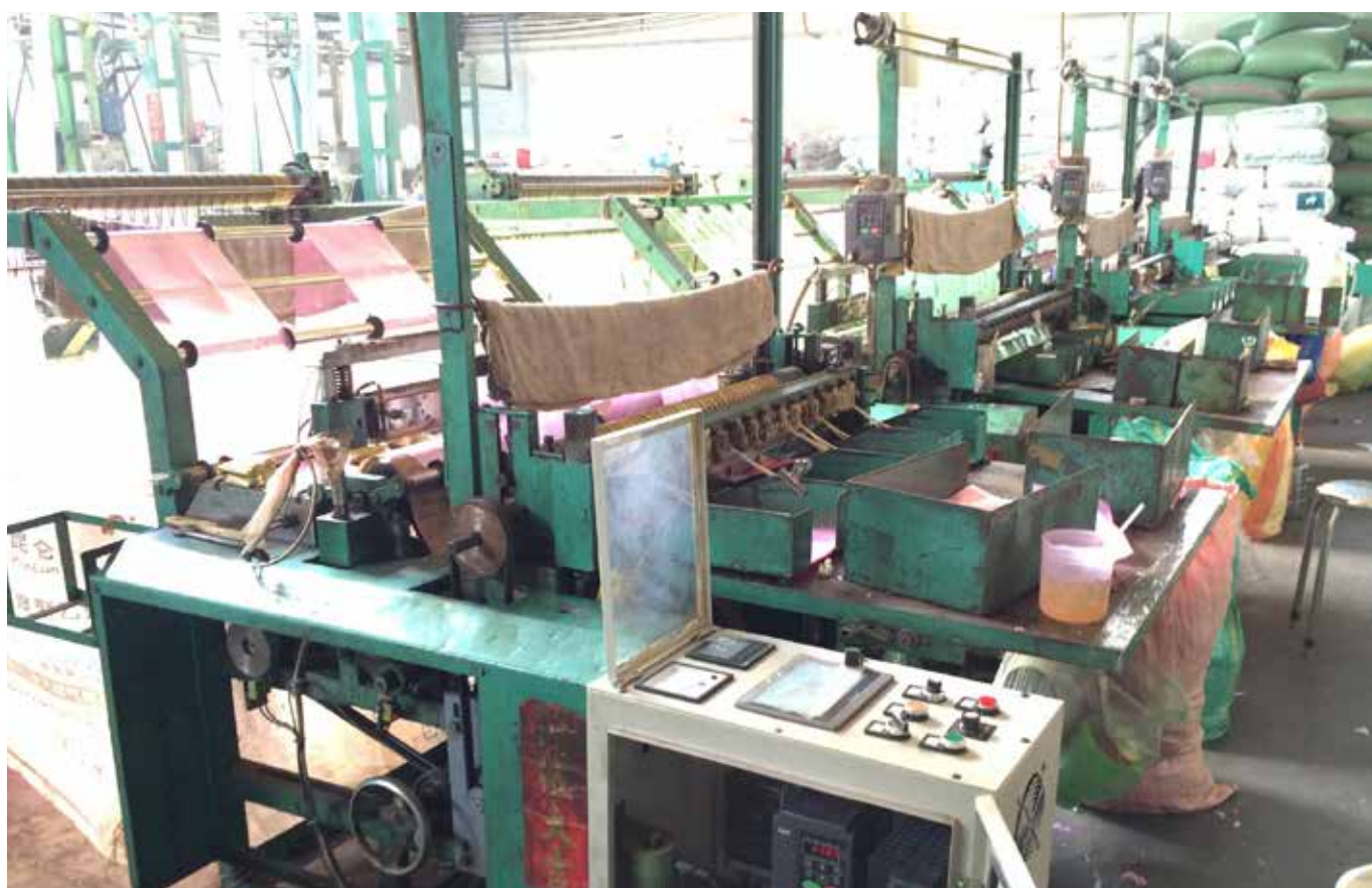
Biến tần CHF100A, Servo, PLC, HMI: Điều khiển máy cắt túi nylon - Ngành bao bì
