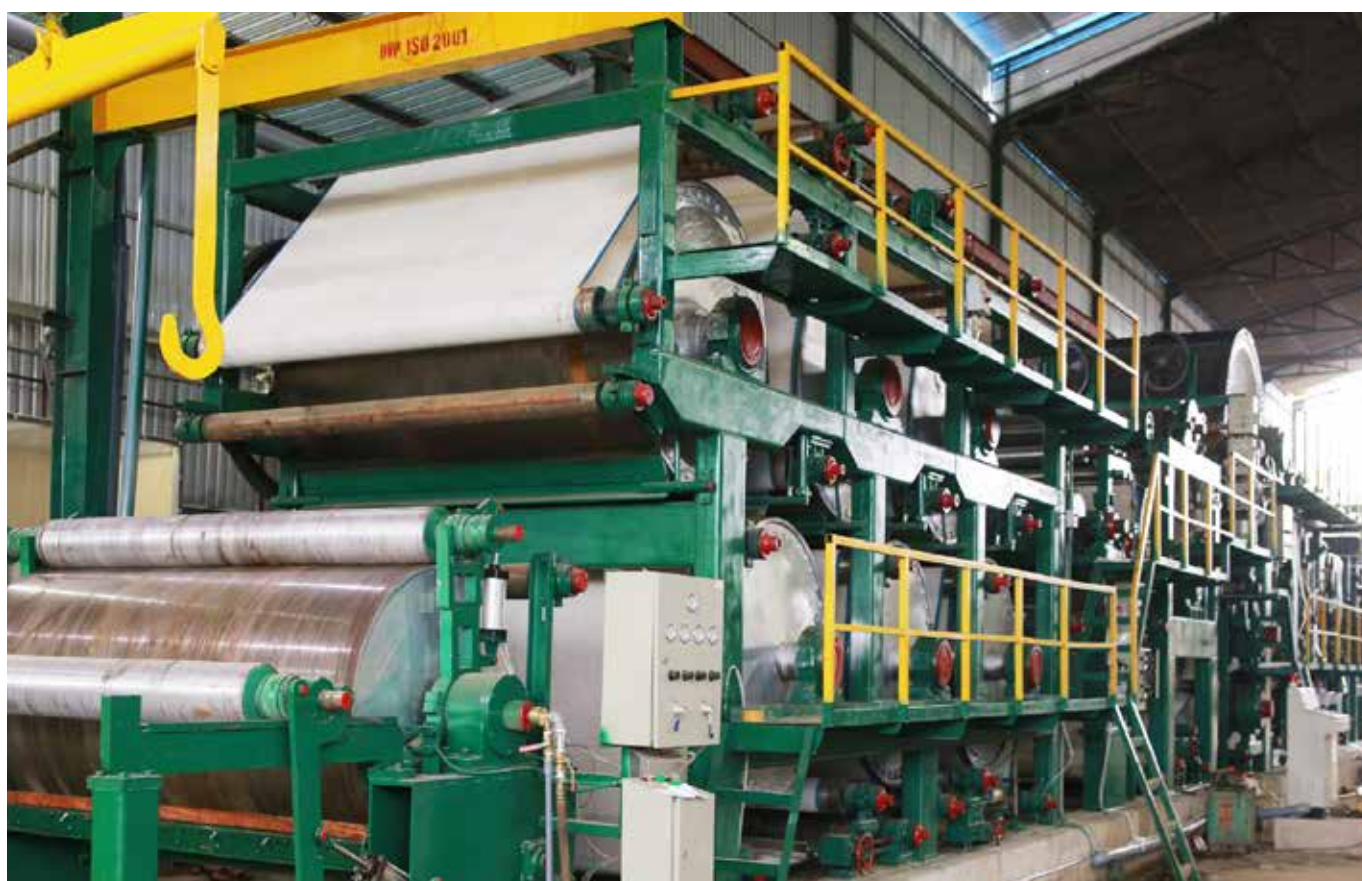
Biến tần INVT và RBU: Tủ điện xeo giấy tốc độ 200m/phút chạy đồng bộ xung cho máy giấy Dương Nguyễn
