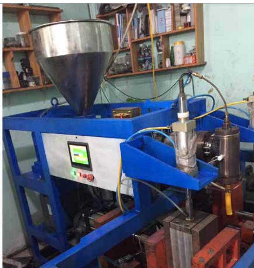
Biến tần GD200A, PLC, HMI, bộ điều khiển nhiệt ITC: Điều khiển máy thổi chai
