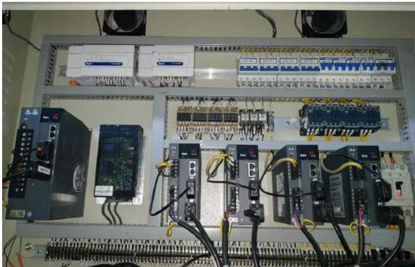
Hệ thống PLC, Servo: Điều khiển máy in lụa 4 màu
