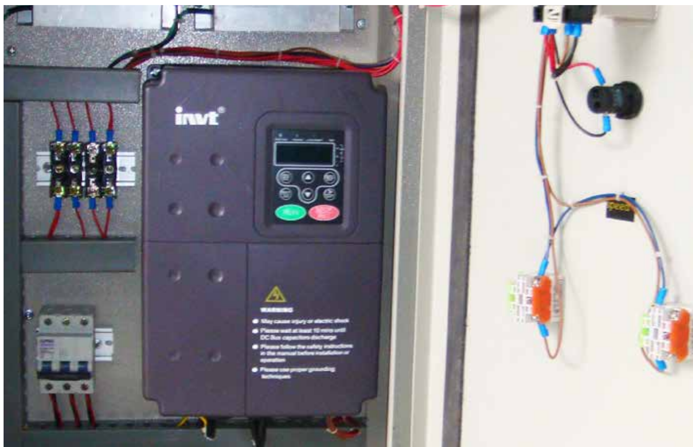
Biến tần CHF100A: Điều khiển máy cắt sang cuộn giấy - Ngành giấy
