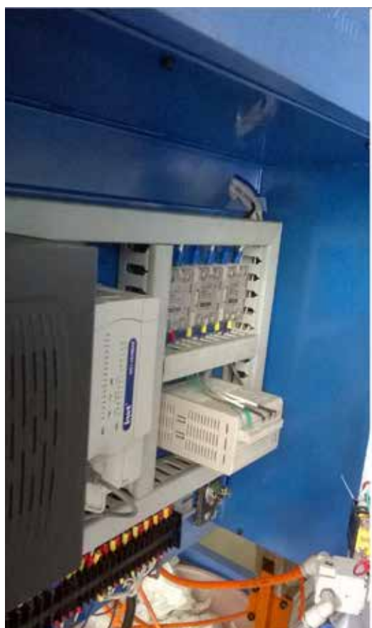
Biến tần GD200A, PLC, HMI, bộ điều khiển nhiệt ITC: Điều khiển máy thổi chai
