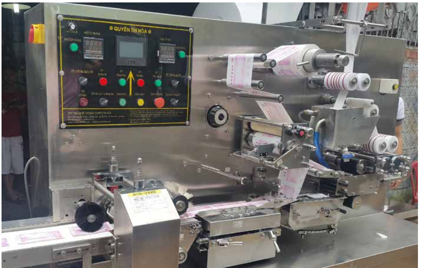
Biến tần GD10, Servo, PLC, HMI: Điều khiển máy cắt khăn giấy
